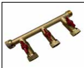
Grenrör 3 Kulventil Inv x inv x inv x inv gänga med lekande mutter x utv gänga
