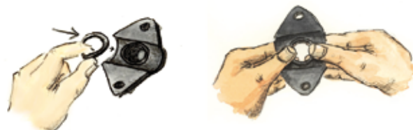
Placera och fixera o-ring i sätet
