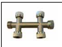
Korsrör , dubbelt Utv x inv x inv x inv x inv gänga med lekande mutter x utv gänga.
