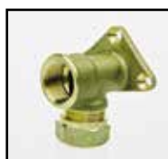
Väggfäste i mässing med anslutning till polyetenslang. Invändig gänga. DD 997 och DD 998 inkl stödhylsa.
