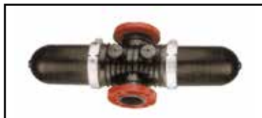
Arkal Lamellfilter i plast DN80 Flänsanslutning Max flöde 40 m 3 /h. Med manometeruttag
