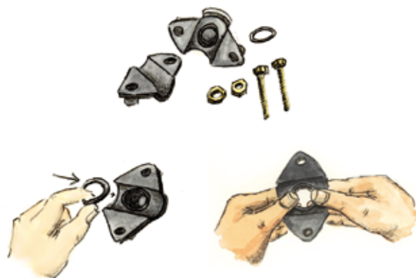
Placera och fixera o-ring i sätet
