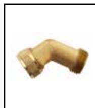
Unionskoppling. Vinkel 45° R20 invändig x utvändig gänga.
