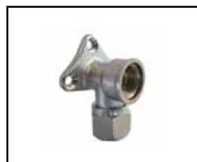
Väggfäste i förnicklad mässing med R15 invändig gänga och anslutning till 15 mm Cu-rör
