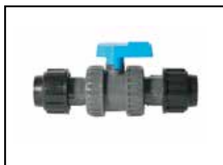
Kulventil i PVC med PEM- slanganslutning. Försedd med unionskoppling för att underlätta montage. Tryckklass 16 bar.
