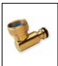
Krananslutning i vinkel med R20 invändig gänga, lekande svivelfunktion.
