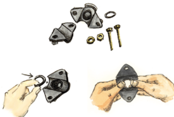
Placera och fixera o-ring i sätet
