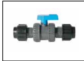
Kulventil i PVC med PEM- slangsanslutning. Försedd med unionskoppling för att underlätta montage. Tryckklass 16 bar.
