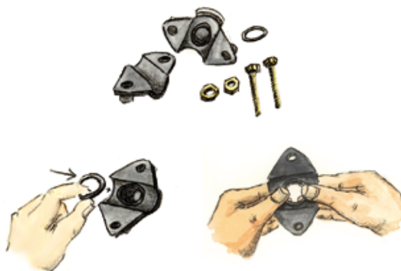
Placera och fixera o-ring i sätet
