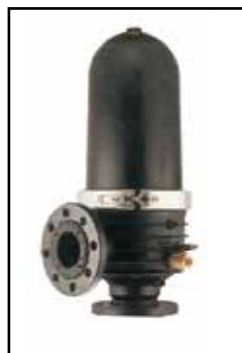
Arkal lamellfilter i plast DN100 flänsanslutning Max flöde 60 m 3 /h Med manometeruttag
