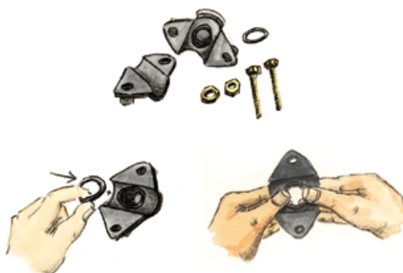
Placera och fixera o-ring i sätet
