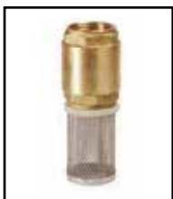
Bottenventil i mässing, fjäderbelastad, med löstagbar sil, modell Europa.
