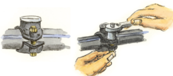
Montera bult och mutter löst för att sedan dra åt jämnt på båda sidorna av bygeln
